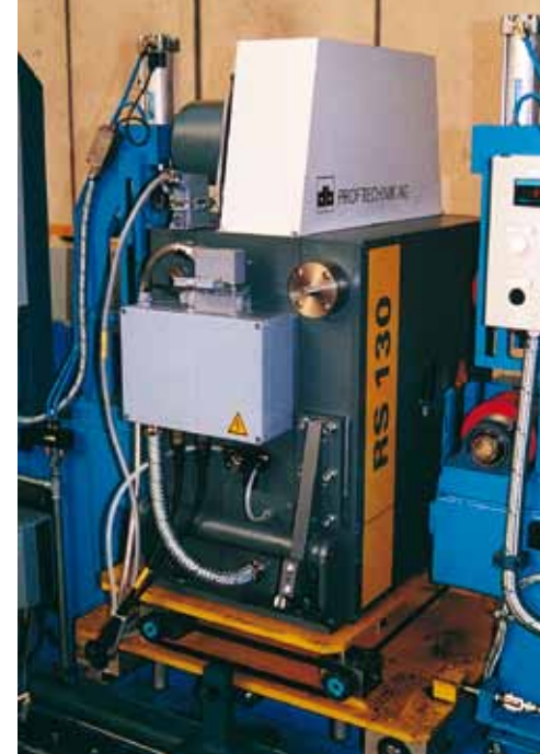
Testes Offline de tubos e barras de aço circulares utilizando o Sistema Rotativo RS130
