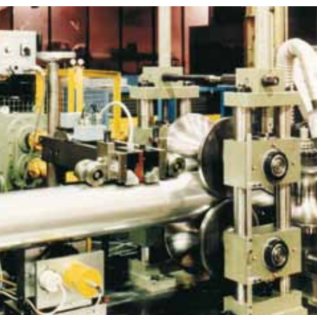
Inspeção de soldas com unidade de magnetização longitudinal e bobina de segmento.
