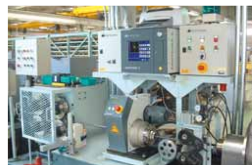
Inspeção Inline na produção de arames para molas
