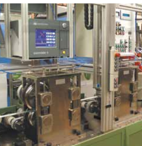
Inspeção de soldas em tubos de alumínio utilizados em radiadores
