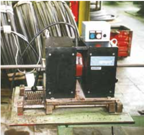
Schweißnahtprüfung von Stahlrohren
