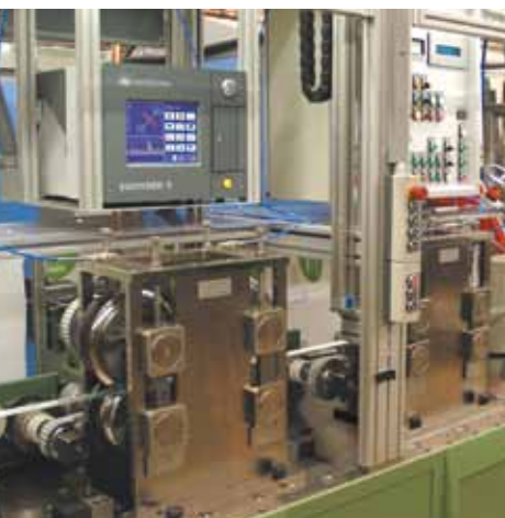
Schweißnahtprüfung von Aluminium-Kühlerrohr
