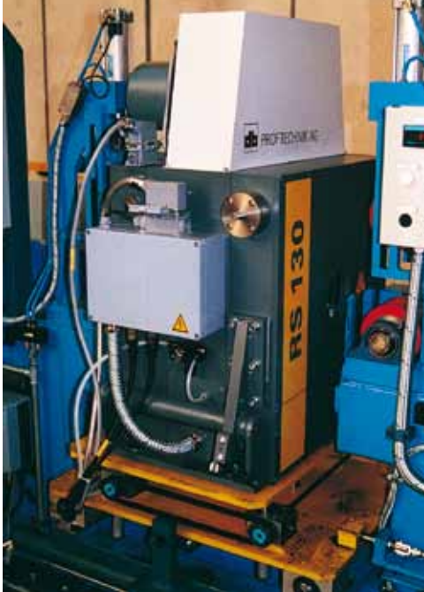
Offline-Prüfung von Blankstahl mit Rotiersystem RS 130
