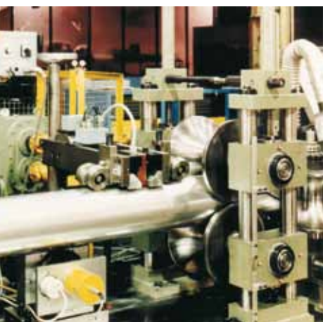
Instalación para la inspección de soldaduras con sondas segmentadas y una unidad magnetizadora longitudinal
