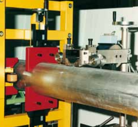
Inspección completa con multisondas segmentadas e inspección de soldadura
