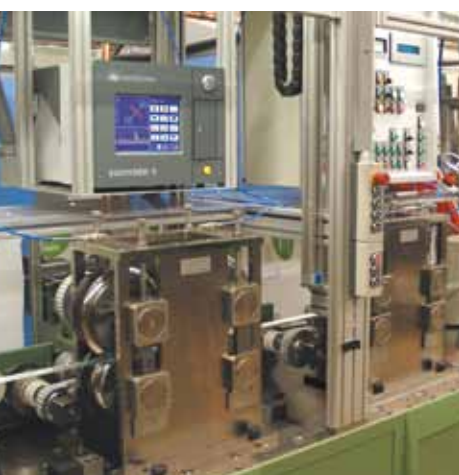
Inspección de soldadura de tubos de refrigeración de aluminio
