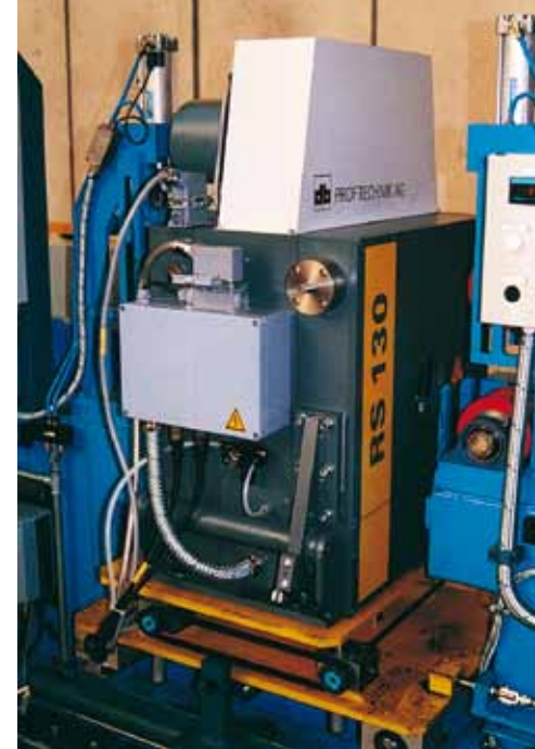
Controllo fuori linea di materiale pelato con testa rotante RS 130
