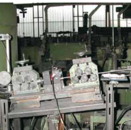
Controllo in linea di trafilatura
