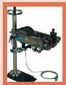
Unità di magnetizzazione longitudinale
