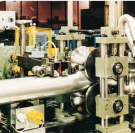
セグメントコイルとh磁化ユニットを搭載した溶接継目試験装置
