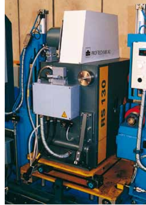
回転システム RS 130を使い、黒皮のない鋼材を生産ライン外で試験
