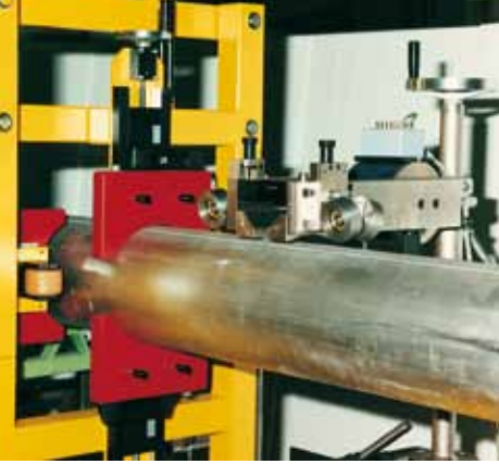
複数のセグメントコイルによる外周試験と溶接継目試験
