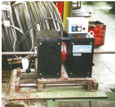
Controlul sudurii la tevi din oțel
