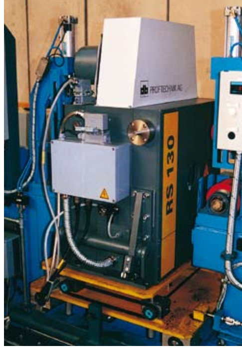
Controlul offline a barelor prelu crate cu un sistem rotativ RS 130
