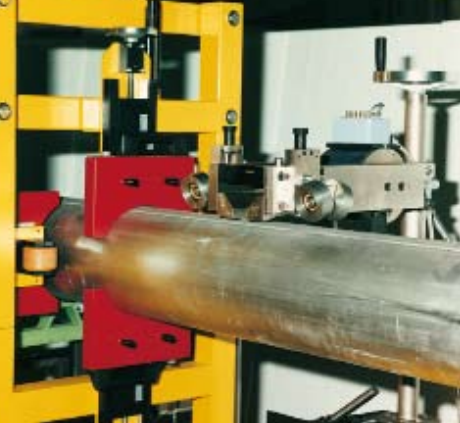
Не разрушающий контроль с помощью многосегментных катушек и проверка качества сварного шва
